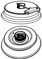
Afin de garantir l'étanchéité aux aérosols, le couvercle d'un rotor avec tube à orientation libre étanche aux aérosols doit être correctement fermé.
