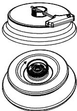
Per garantire la tenuta agli aerosol, il coperchio di un rotore angolare a tenuta di aerosol deve essere ben chiuso.
