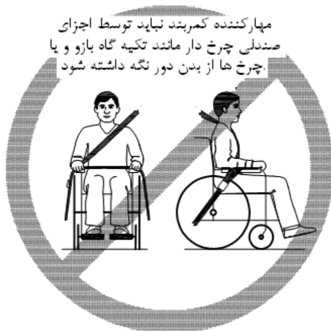
شکل ۶- تصویر نصب نامناسب کمربند محافظ
