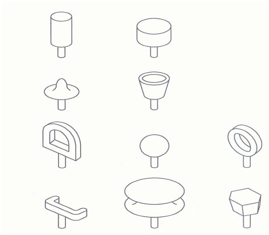
شکل ۸ مجموعه اشکالی که می توانند تنها به وسیله لمس کردن تشخیص داده شوند
