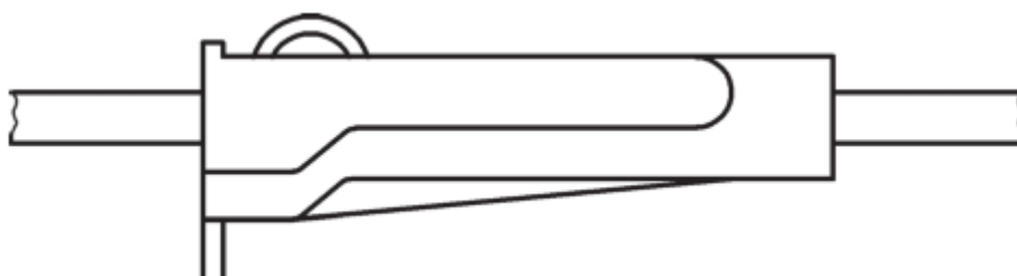
شکل ۳- نمونه گیره و تنظیم کننده جریان (که به تنظیم کننده قرقره ای مشهور می باشد) (به طور شماتیک)
