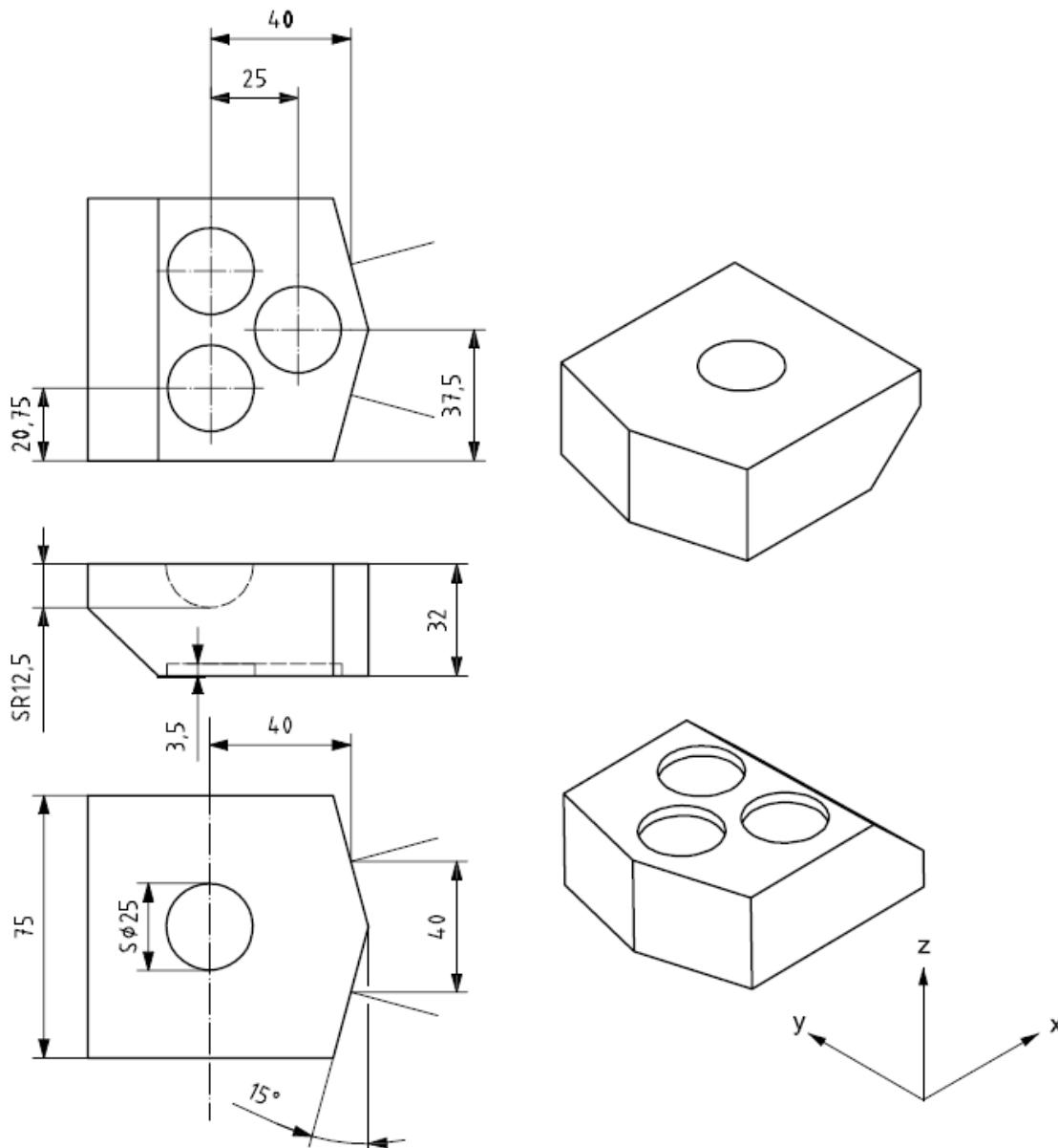
شکل ۲- پایه آزمون UHMWPE دو طرفه کمری برای پیچ ها یا بولت ها<sup>۱</sup>
