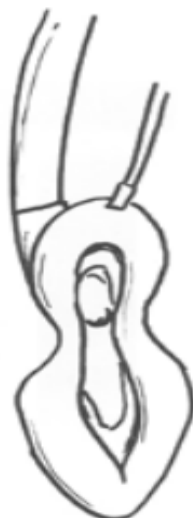
شکل الف-۱- مثالی از تا شدن به داخل (in-folding)
