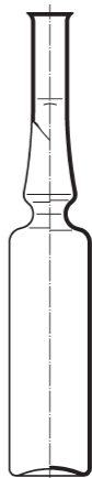
ت- مثالی از آمپول قطع گلوئی بوسیله تنگ‌شدگی (به استاندارد ISO 9187-1 مراجعه شود)
