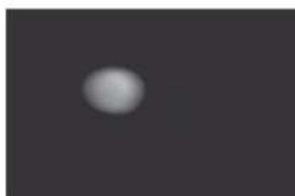
الف- نمونه‌ای از تصویر فلورسانس ناشی از لیزر روی نمونه اپتیکی ایجاد شده به وسیله آلاینده مولکولی ناشی از لیزر
