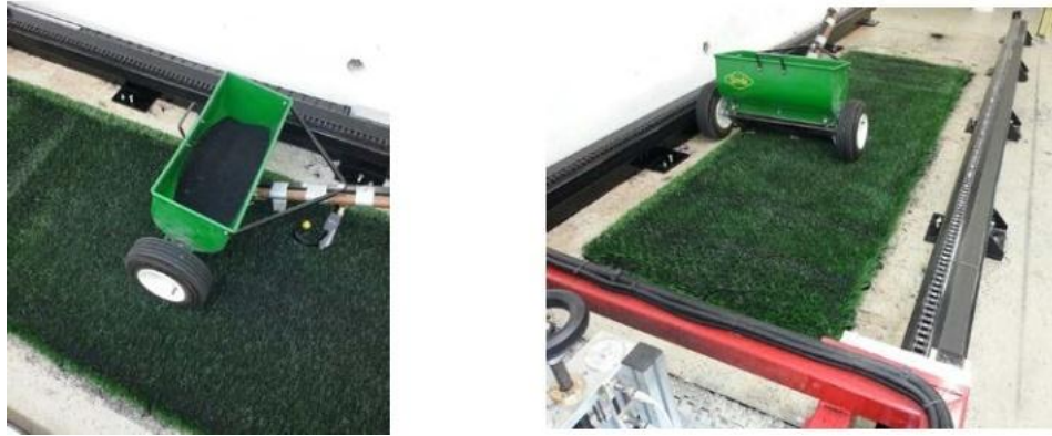
شکل ۱۹- تصویر نحوه پخش مجدد پرکننده
